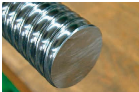
Fig. 10.2 Estremità dell'albero prima dell'assemblaggio del raschiatore in NBR/TPU
