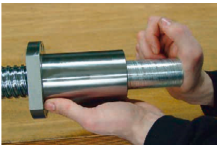
Fig. 10.5 Montaggio della chiocciola con tenuta NBR/TPU sull'albero
