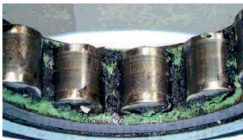
Deterioramento del lubrificante causato da correnti di scariche elettriche
