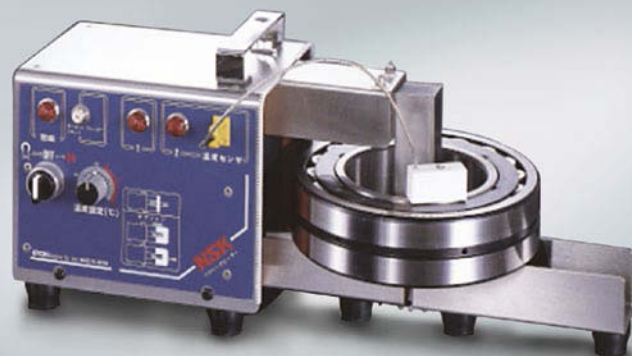
Fig. 5: Riscaldatore ad induzione per cuscinetti
