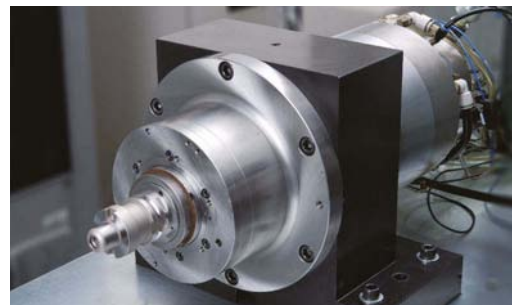
Mandrino NSK che ha raggiunto 4 milioni d_m n utilizzando cuscinetti con sfere in ceramica
