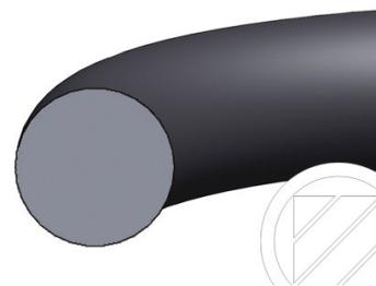
La corda O-Ring e gli O-Ring ricavati da corda di DICHTOMATIK realizzano il loro effetto di tenuta tramite la deformazione della sezione dopo installazione e compressione nella sede. Come guarnizioni statiche sono eccezionali per tenuta su flange e raccordi.
